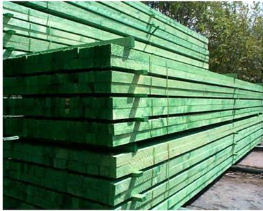
**Latten** (z.B. 24 x 48 mm, 30 x 50 mm, 38 x 58 mm oder 60 x 80 mm) roh, imprägniert oder auch technisch getrocknet
